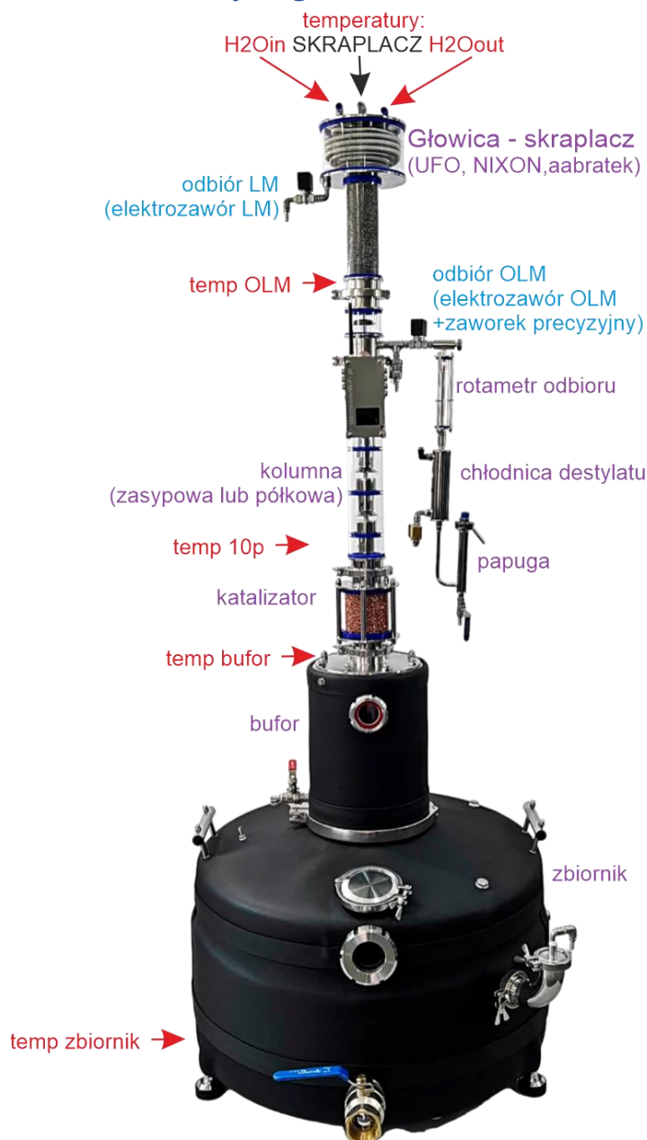
rys. 1 Schematyczna budowa kolumny rektyfikacyjnej
