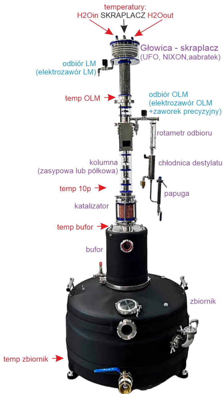
rys. 1 Schematyczna budowa kolumny rektyfikacyjnej
