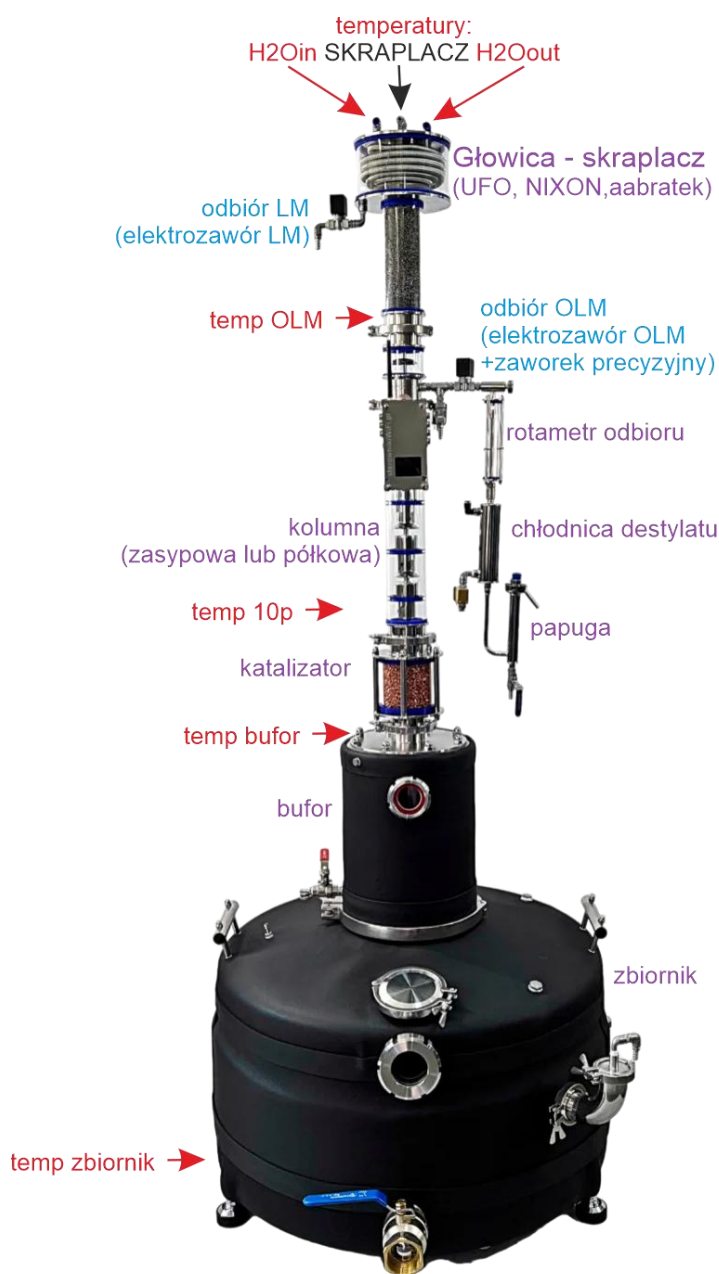
rys. 1 Schematyczna budowa kolumny rektyfikacyjnej
